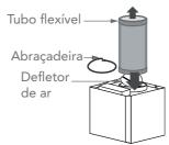
**NOTA:** Recomendamos que a seção vertical do Duto flexível, após a fixação na saída de ar do motor (defletor de ar), não ultrapasse o comprimento de 1 metro, antes de ser direcionada para seção horizontal da saída de exaustão. Caso não haja viabilidade técnica, deve-se utilizar o menor comprimento possível para o direcionamento da seção horizontal de saída da exaustão. Veja exemplo na figura a seguir.
